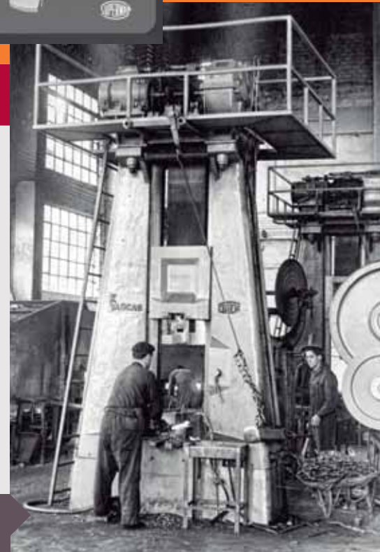
1965. El Martillo de Caída para la fabricación de Bridas representó una auténtica revolución en los procesos de Producción de GAITU y ENARA.
