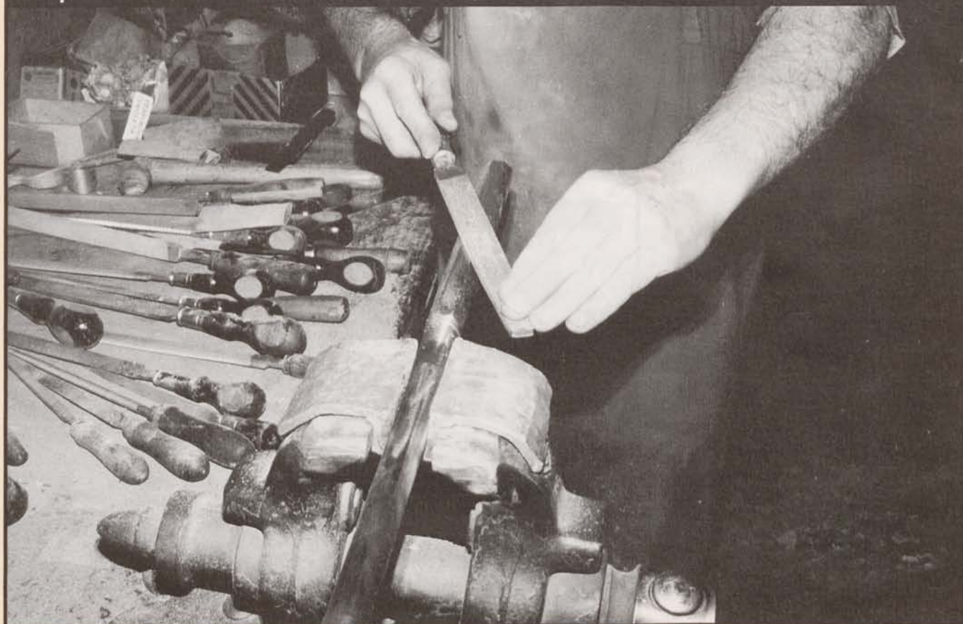
Comprobación del enderezado interior de un cañón (foto Amaia Ros).
