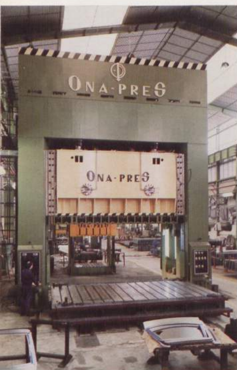
Prensa de triple efecto de 1.500 Tns. (Ona Pres)
