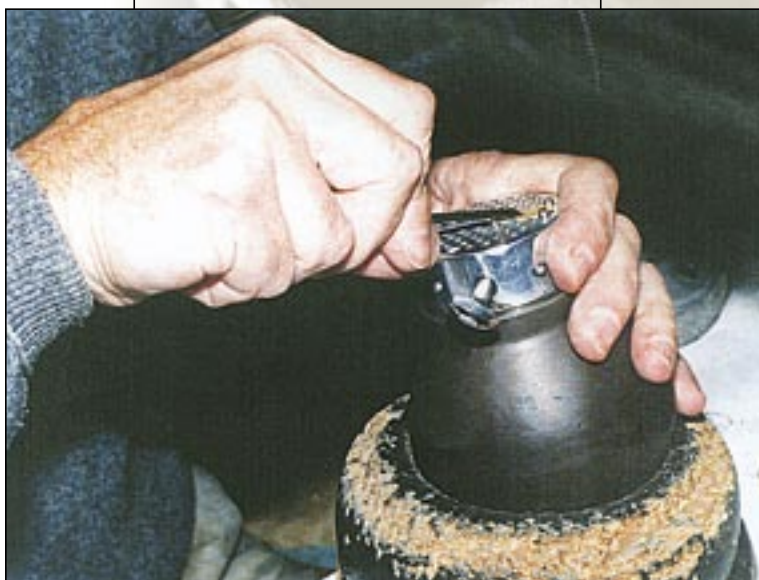
Grabando un nombre y una fecha sobre una medalla, sujeta sobre la bola.
