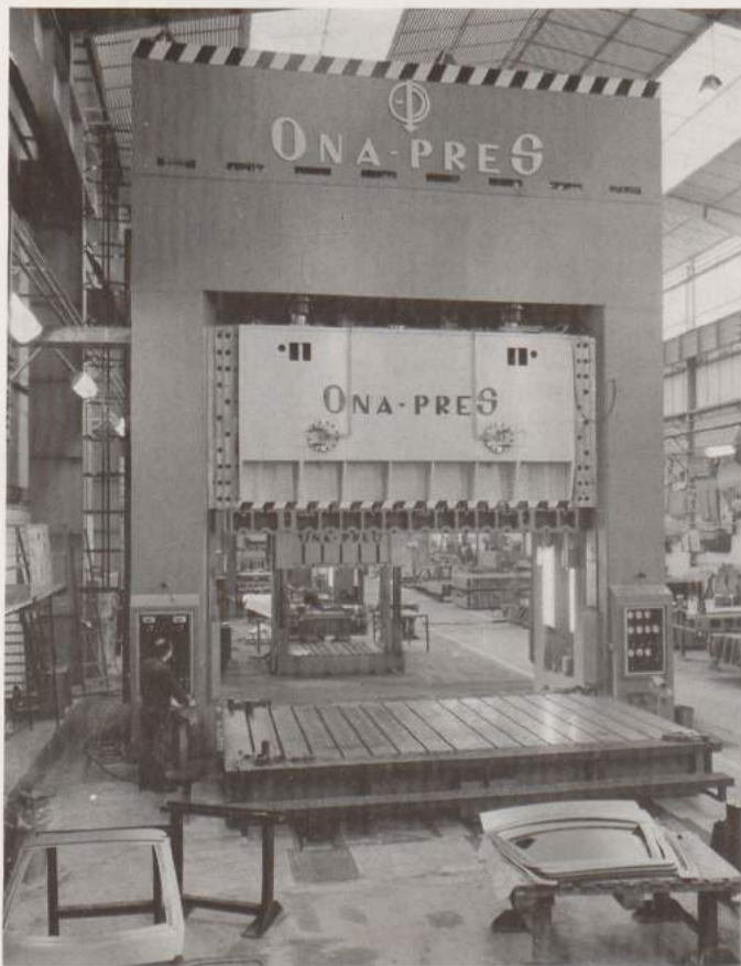
Prensa de 1.200 Ts. instalada en Matrici, en la línea de las suministradas a Volvo y Alemania del Este.
