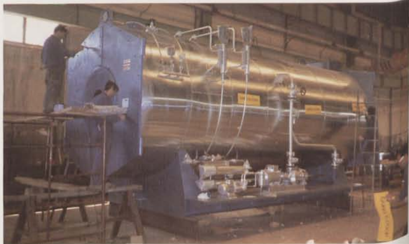
Caldera de vapor pirotubular de Gaiko
