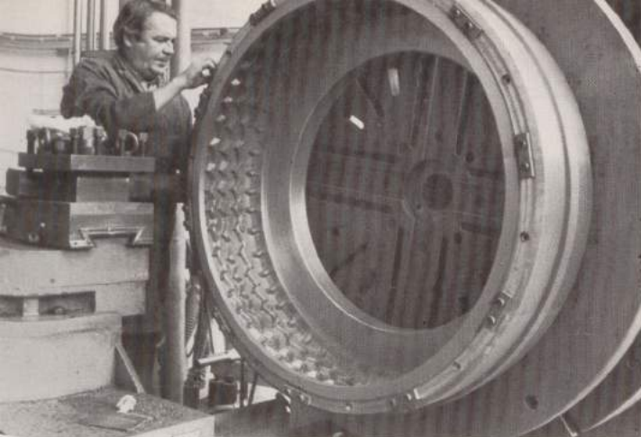
Molde para vulcanizado de neumático en Aurrenak.
